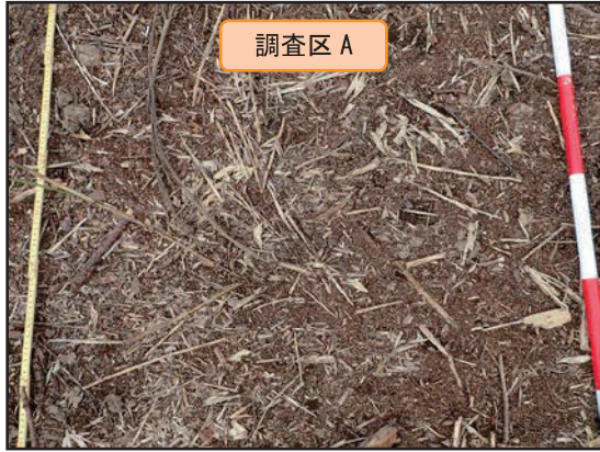
写真4 機械の走行回数が10回の小区画（10回区）におけるリター層の状態
