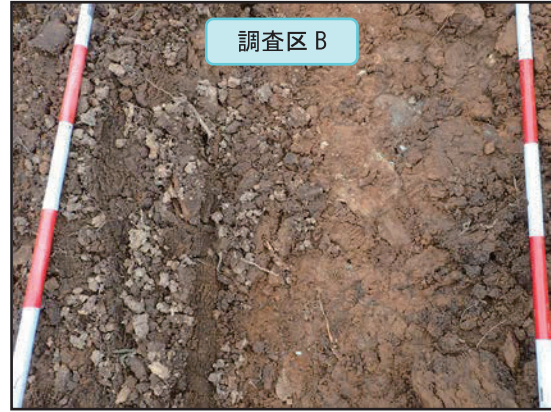
写真4 機械の走行回数が10回の小区画（10回区）におけるリター層の状態
