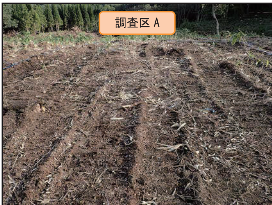
写真3 機械の走行回数が10回の小区画（10回区）における地表面の状態
